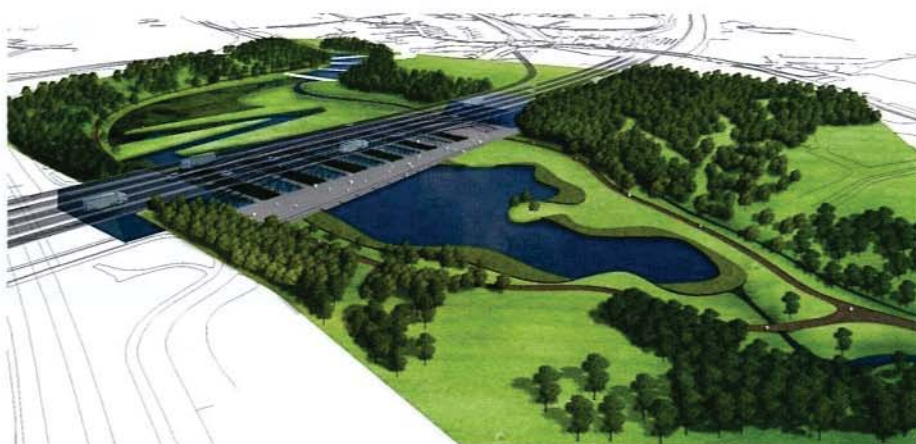
Forslag til vannrensepark på Breivoll. Parken, som er ca. 200 000 m 2 , skal kunne fange opp meste-parten av det forurensete vannet i Alna. Vannet renses ved hjelp av planter, og rent vann vil bli ledet til Oslofjorden. Samtidig åpner parken for økt utlufting av stagnert luft i dalen. I sin størrelse og plassering er parken tenkt å være et ikon for visjonen om en ny og renere Groruddal.
